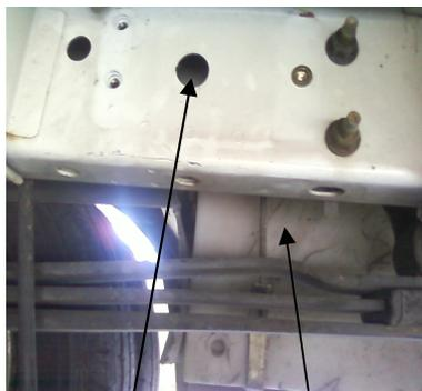
trou treuil roue de secours ici déposé
