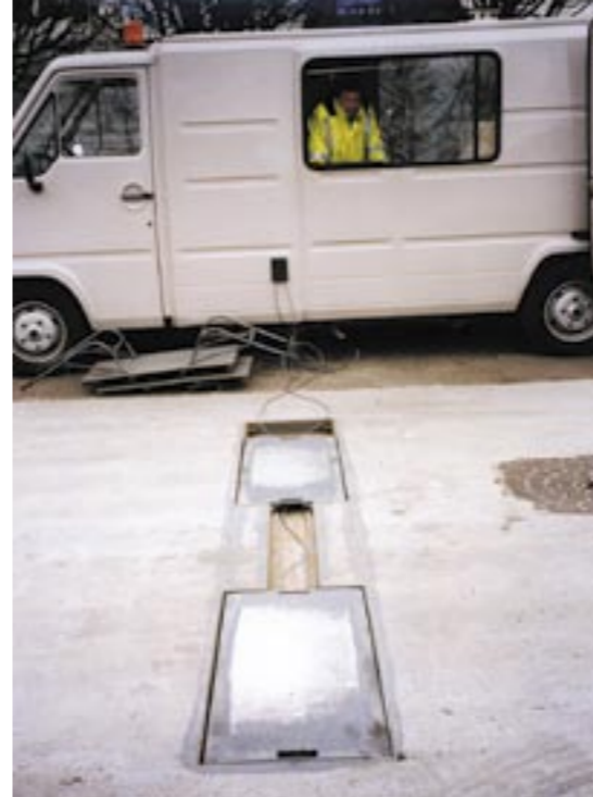
Pesage statique avec pesons semi-fixes Captels - LROP
