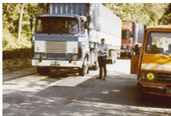
Contrôle de pesage dynamique à basse vitesse -LROP
