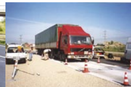
Pesage dynamique à basse vitesse - LROP
