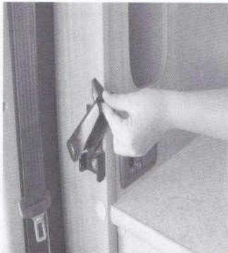
2 Abaisser la butée inférieure du lit se trouvant sur la droite de la cabine chauffeur.
