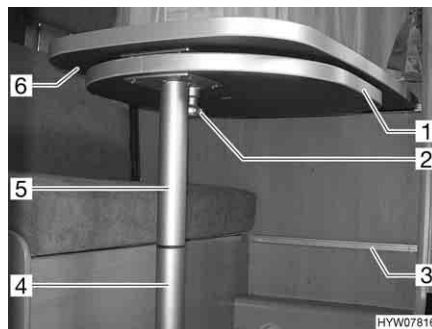
Fig. 82 Table suspendue avec pied d'appui divisible
