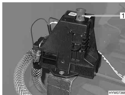
Fig. 155 Valve de sécurité et de vidange du chauffe-eau
