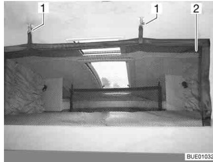
Fig. 93 Lit escamotable avec filet de sécurité tendu
