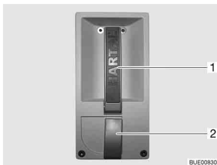
Fig. 34 Serrure de la porte cellule, à l'intérieur
