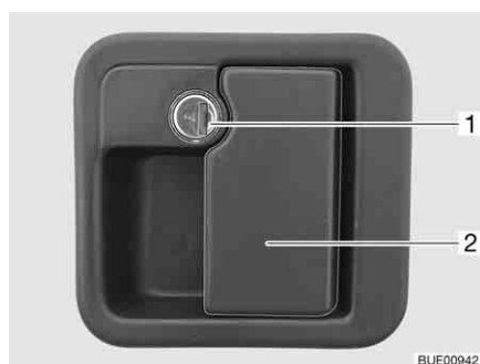
Fig. 29 Serrure de la porte cellule, à l'extérieur
