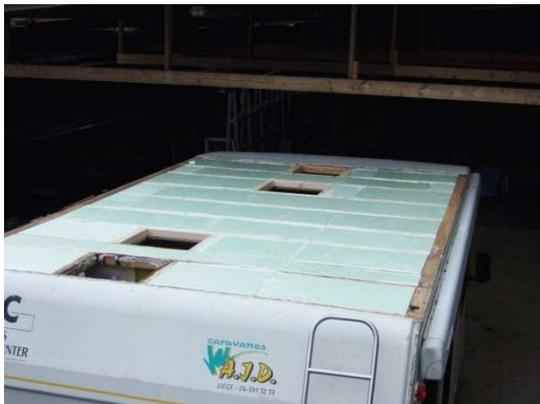
Etape 5 : pose des panneaux triplex (verniss) de 9mm sur tout le toit
