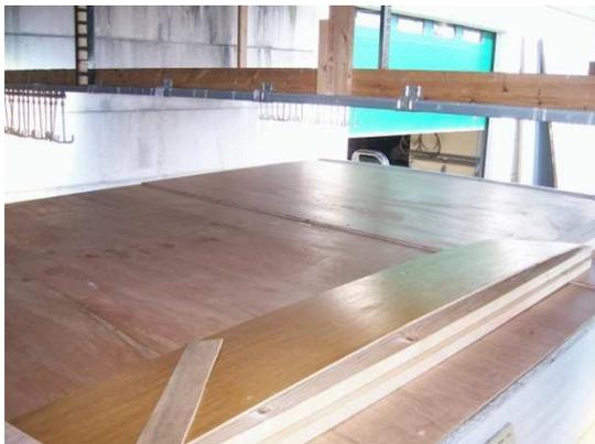
Etape 6 : pose de la tôle collée au sica sur le triplex et replier/agrafer les bords sur les panneaux verticaux puis remettre les cornières du CC ..
