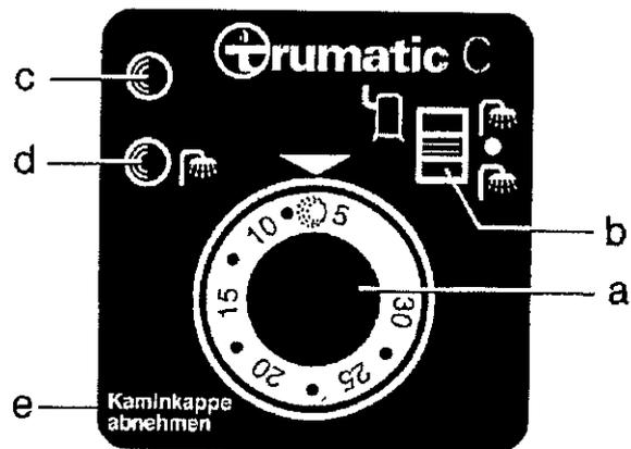
**Bloc de commande avec thermostat**
