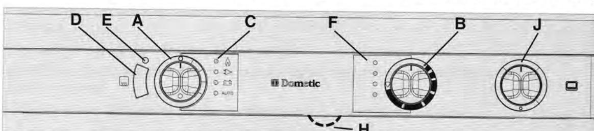
A = commutateur de sélection de la source d'énergie (réfrigérateur)
