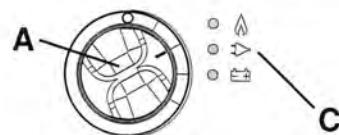
1. Réglez le bouton de sélection d'énergie " A " sur 230V. L'affichage de fonction " C ", 230V, affiche une lumière verte. L'appareil est en fonction.
