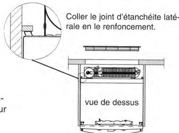
Mettre les joints à lèvres dans le renforcement d'installation en bas et Sur les deux côtés.
