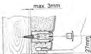
Une fois le réfrigérateur définitivement installé, fixer les vis dans les parois du renforcement à travers l'enveloppe en tôle du réfrigérateur.
