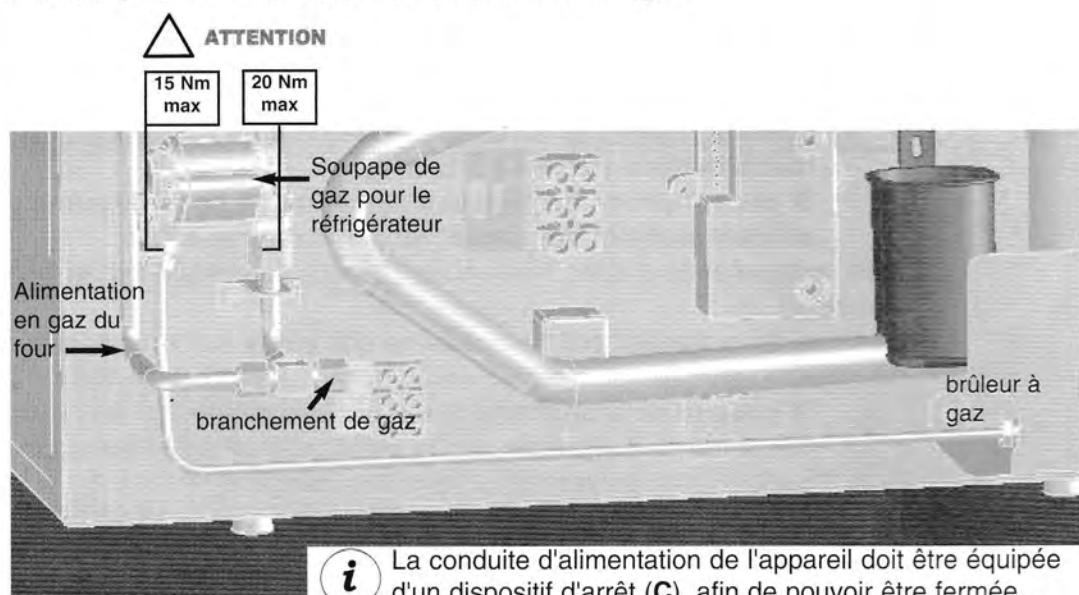
**i** La conduite d'alimentation de l'appareil doit être équipée d'un dispositif d'arrêt (**C**), afin de pouvoir être fermée. Ce dispositif doit être facilement accessible pour l'utilisateur
