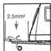
Le circuit interne de bord de 12 V doit être muni d'un fusible de 20A.
