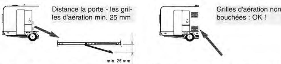
**(Fig. 1)** La grille d'aération est recouverte. L'écart entre la porte et les grilles d'aération doit être de 25 mm minimum ! Lorsque l'écart entre la porte et la grille se trouve entre 25 mm et 45 mm, nous recommandons le montage du **kit de ventilation Dometic (réf. 241 2985 - 00/0)**, afin d'atteindre une performance de réfrigération optimale lors de températures ambiantes élevées.
