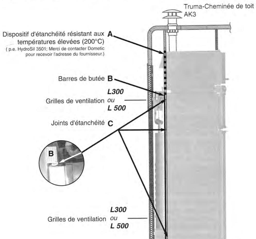
**Installer le réfrigérateur de niveau dans le renforcement.**
