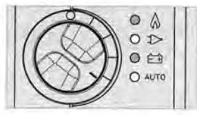
Le type d'énergie sélectionné automatiquement est affiché par un voyant (p. e. fonctionnement 230V).
