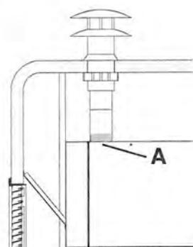
La hauteur minimum d'installation du conduit de cheminée entre l'arête supérieure de l'appareil et la sortie des gaz sur la cheminée ne doit pas être inférieure à 250 mm. Une distance de 1500 mm maximum est possible. Un écart de 50 mm minimum doit être respecté par rapport aux murs/parois et aux composants qui entourent l'appareil.
