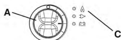
1. Réglez le bouton de sélection d'énergie « A » sur 12V. L'affichage de fonction « C », 12V, affiche une lumière verte. L'appareil est en fonction.
