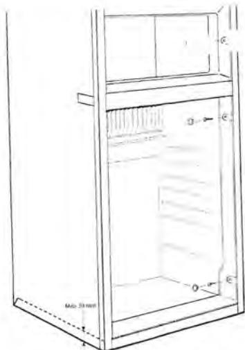
Sur les côtés du réfrigérateur, vous trouverez quatre chevilles en plastique, ainsi que des vis prévues pour fixer l'appareil. Les parois latérales ou les plinthes installées pour fixer le réfrigérateur doivent être conçues de telle manière que les vis ne bougent pas même soumises à des efforts importants (quand le véhicule roule).
