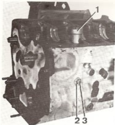
Emplacement du clapet de décharge et fixation de celui-ci (Mot. U 25651)
