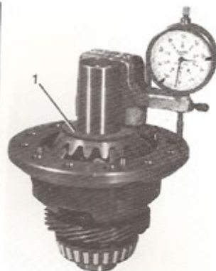
Contrôle du jeu latéral du planétaire gauche 1. Rondelle butée
