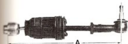
Prérégage de la biellette de direction A. 322 mm
