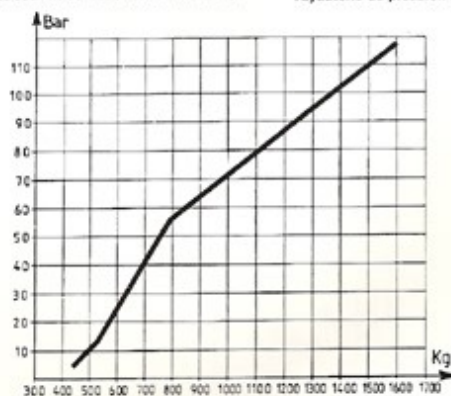
Abaque pour le réglage du correcteur de freinage (Citroën C 25 1 er montage) Bar : Pression de sortie du correcteur de freinage Kg : Charge du véhicule relevée sans l'essieu arrière
