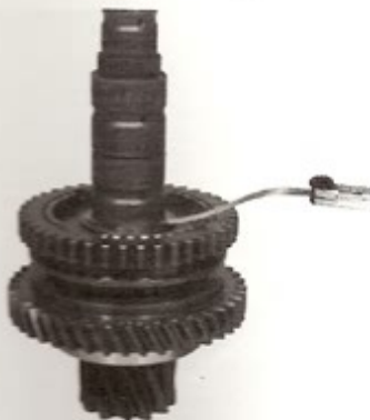
Contrôle du jeu latéral sur le synchro de 1 er , 2 e
