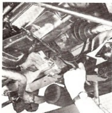
Utiliser une chasse pour sortir la transmission côté gauche
