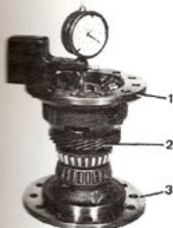
Contrôle du jeu latéral sur le planétaire côté embrayage (côté droit)
